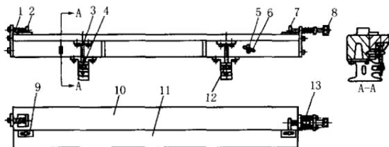
图 2 钢直尺检定台示意图
